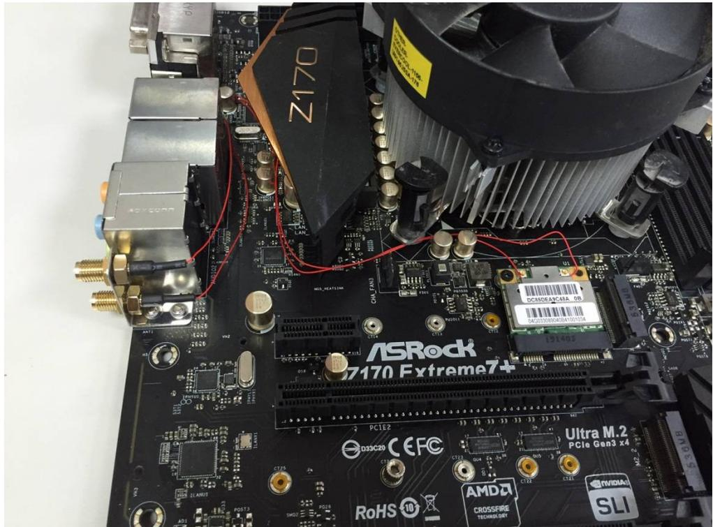
Schritt 3: Installieren Sie das I/O-Schild vom Z170 Extreme7+ wieder, wie auf dem folgenden Foto.
