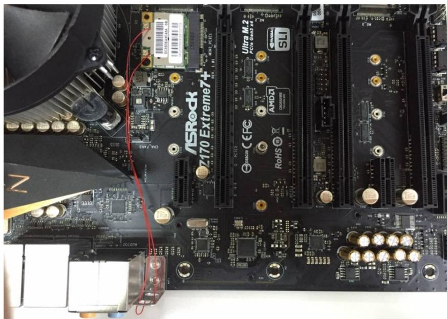
Wenn die Verbindungskabel zwischen den WLAN-Antennen und der WLAN-Karte für den Mini-PCIe-Slot länger sind als 26 Zentimeter, befolgen Sie bitte die folgenden Schritte:
