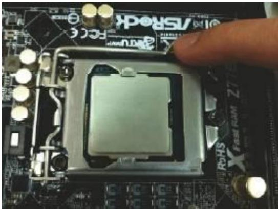
**Тип Б: Защитно процесорно капаче в процесорния цокъл.**
